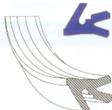
Slika 3. Dvojni posnemalni obroč z razbremenilno membrano in "dežnikom"
