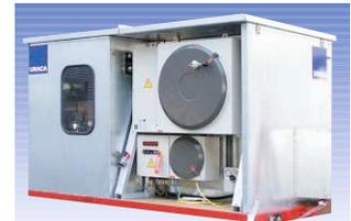
▲▲ Hochdruck-Pumpenaggregat KD 724 Ex-geschützt nach ATEX
