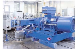
Hochdruck-Pumpenaggregat P 5-80 auf dem
