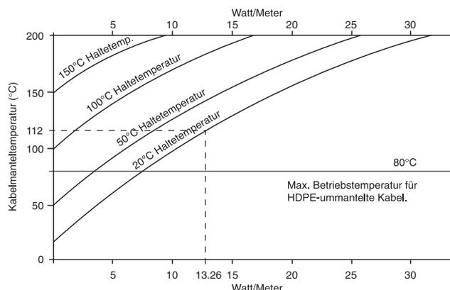
Verfahren Sie entsprechend den nachstehenden Schritten, um die Ummantelungstemperaturrichtlinien für Anwendungen in nicht Ex-Bereichen aus der Graphik abzuleiten.
